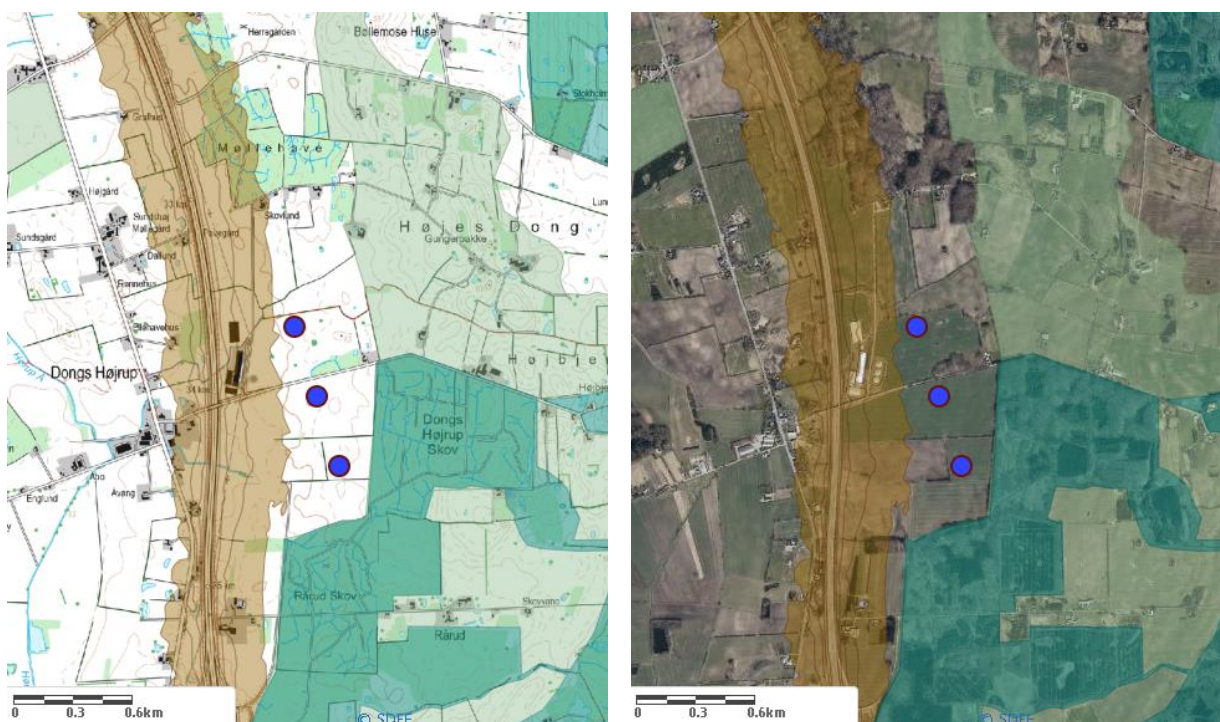
Figur 5: Placering af 3 vindmøller set i forhold til støjbelastet zone langs Svendborgmotorvejen (brun) samt bevaringsværdigt landskab, større sammenhængende landskab, økologisk forbindelse samt naturbeskyttelse (grønne nuancer) vist på hhv. topografisk kort og luftfoto.
